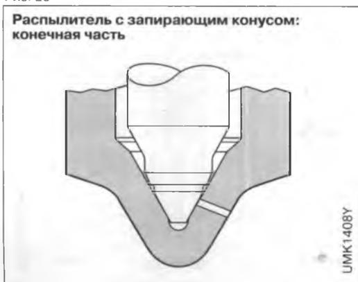
Такой распылитель имеет цилиндрическую и полусферическую части, что позволяет конструкторам иметь большую свободу выбора, касающегося:
